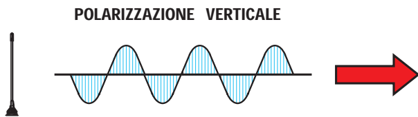
Fig.32 Collocando un dipolo in posizione verticale, le onde radio si propagheranno con una polarizzazione verticale rispetto al suolo.
