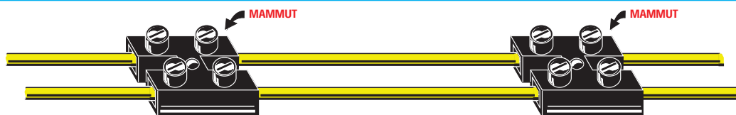
Fig.3 Per tenere distanziate le tre linee di 5-6 millimetri si possono usare dei distanziatori in plexiglas o meglio ancora dei morsetti mammut reperibili presso qualsiasi negozio di materiale elettrico. Facciamo presente che, distanziando le linee parallele più di 6 millimetri, aumenta la frequenza di risonanza dell'antenna.
