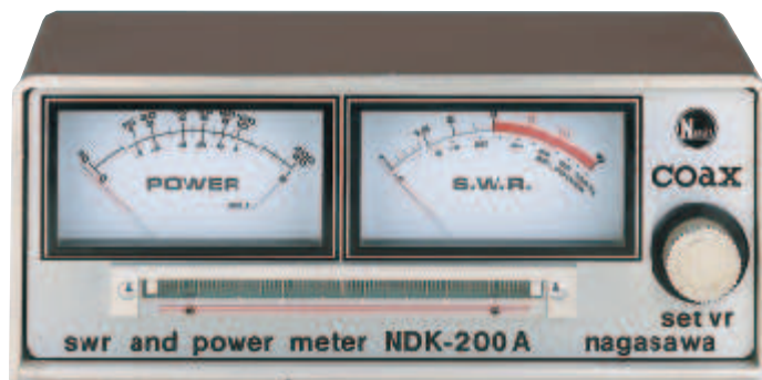
Fig.8 Foto di un misuratore SWR di tipo commerciale. Lo strumento di sinistra indica la potenza delle onde dirette, mentre quello di destra il rapporto delle SWR.
