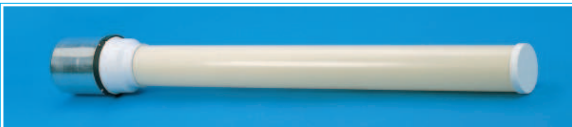
Fig.14 Per proteggere la spirale dalla pioggia e ancora più dalla neve, potrete applicare sull'antenna un tubo di plastica che troverete, con diametri diversi, presso tutti i rivenditori di materiale edile.
