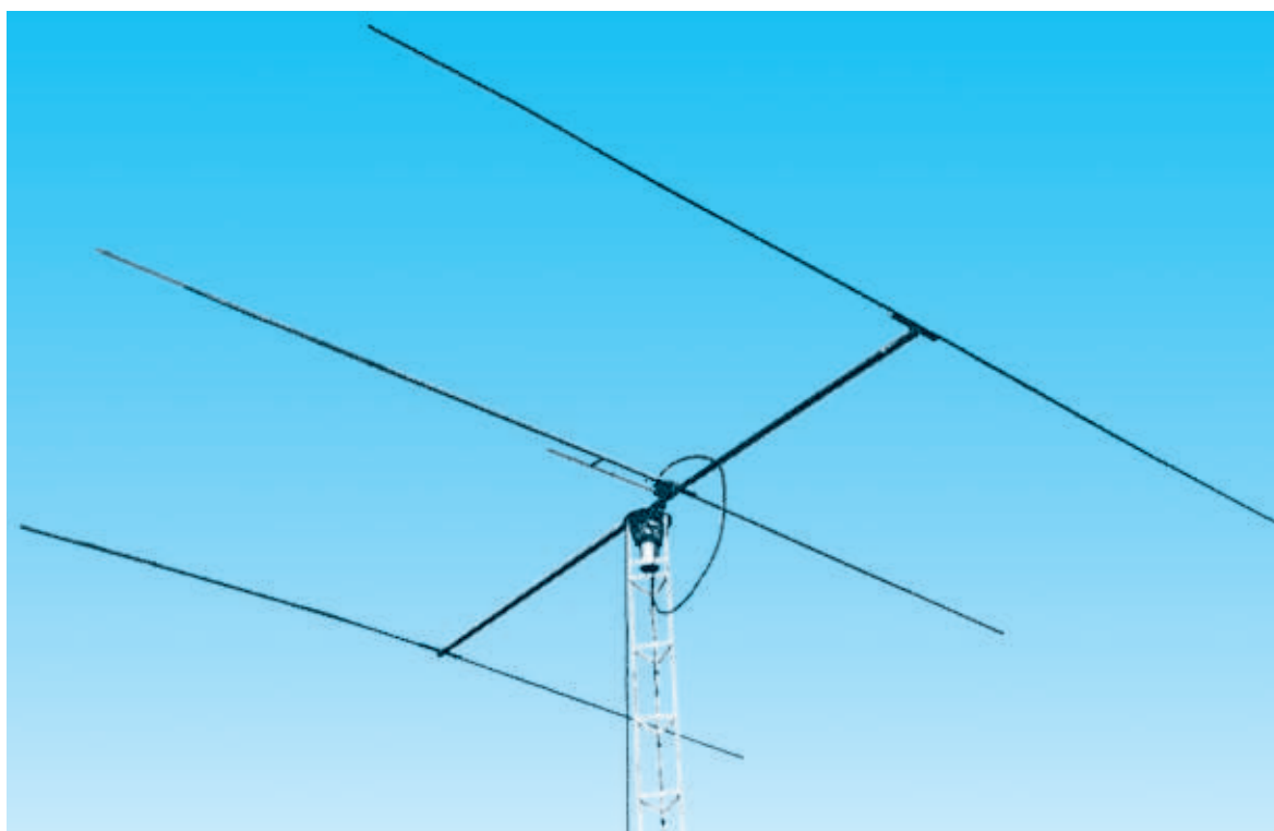
Fig.11 Un'antenna Yagi per gamme decametriche composta da un Riflettore-Dipolo-Direttore. Per calcolare la lunghezza degli elementi e la loro spaziatura consigliamo di utilizzare le formule riportate nell'articolo o nella Tavola della Yagi a 3 elementi.
