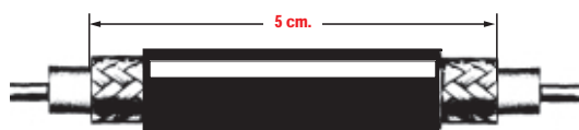
Fig.8 Il cavo coassiale RG.8 ha una capacità di 0,96 picofarad x cm, quindi se ne taglierete uno spezzone lungo 5 cm otterrete un condensatore da 4,8 pF.
