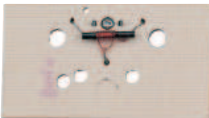
Fig.10 Nelle sole antenne riceventi si usano delle minuscole ferriti del diametro di 2 mm e del filo da 0,25-0,3 mm. Nelle antenne TV questo trasformatore risulta applicato dietro al circuito stampato che sostiene i morsetti d'ingresso.
