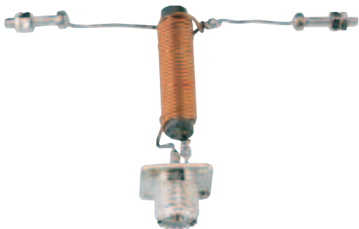
Fig.9 Foto di un trasformatore da bilanciato a sbilanciato avvolto su un nucleo cilindrico in ferroxcube. Se usate questo trasformatore in trasmissione, dovete utilizzare per gli avvolgimenti del filo di rame smaltato da 1-1,2 mm.
