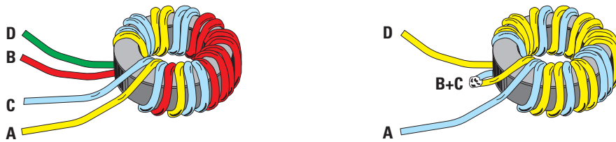
Fig.4 Il trasformatore siglato T1 si ottiene avvolgendo sul nucleo toroidale incluso nel kit, 10 spire utilizzando un filo bifilare. Il filo d'inizio A va collegato alla pista di R2-R1 e il filo terminale B alla pista visibile in fig.6 insieme al filo d'inizio C del secondo avvolgimento. Il filo terminale D va collegato alla pista di R3-R4.
