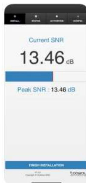
Il sistema non aggancia il satellite o il collegamento diventa instabile se il segnale SNR risulta inferiore ai 10 dB, mentre il valore massimo della resistenza del cavo coassiale non deve superare i 2 ohm. Questi valori sono indicati nel display.
