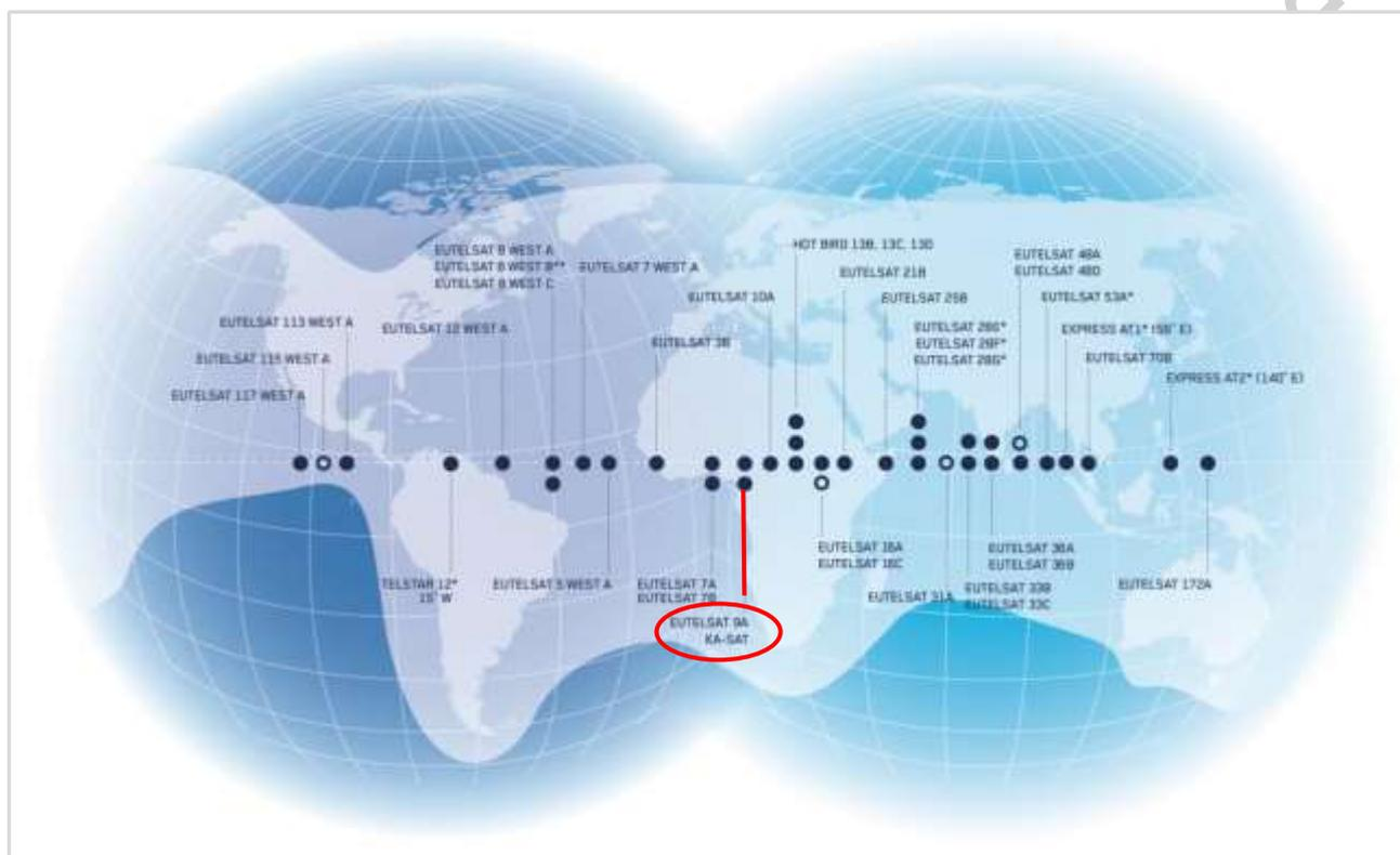
KA-SAT è operativo in banda **Ka** (frequenze operative: 17.7- 20.2 GHz Downlink, 27.5- 30.0 GHz Uplink) e fornisce un servizio di connettività commercializzato con il nome **TooWay**.
